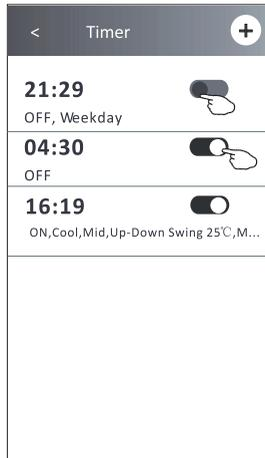
Deslice hacia la izquierda para desactivar el temporizador.
